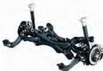
Zadní náprava prošla v systému SKYACTIV optimalizací geometrie
