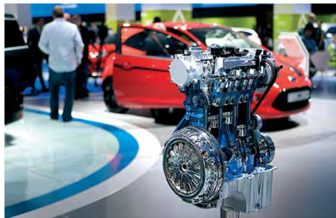
Nový zážehový tříválcový motor EcoBoost 1,0 l
