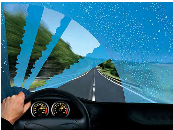
Poskakování napříč sklem signalizuje poškození některé z částí stěrače
