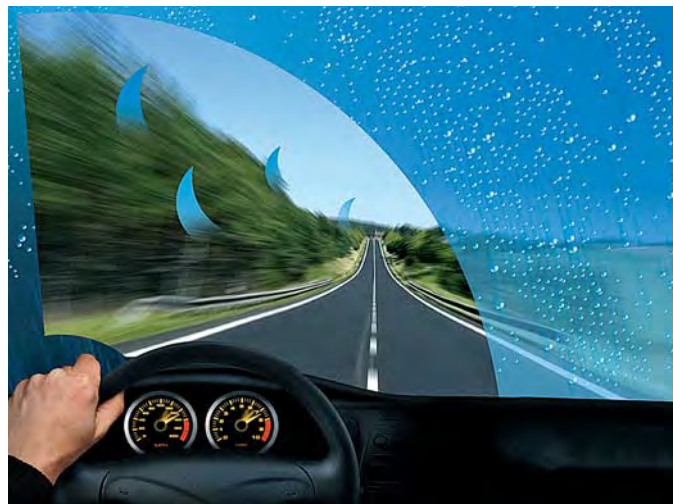
Nadzvedávání stěrače a neseťřené plošky vyžadují okamžitou výměnu
