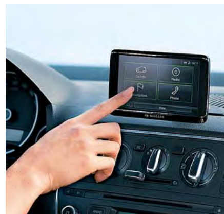
Pomocí pětipalcového dotykového displeje lze ovládat pokročilý informační systém Move&Fun
