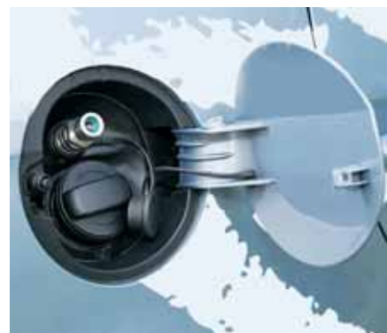
Plnicí hrdla VW Passat TSI EcoFuel – nahoře na CNG, dole na benzin
