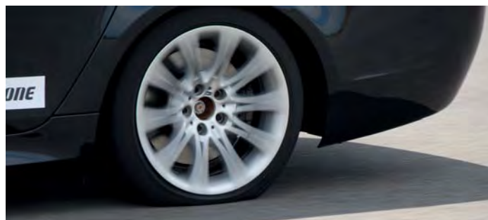
Pneumatiky RFT umožňují bezpečný dojezd i při ztrátě tlaku v plášti
